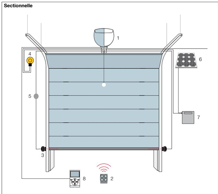
1. Spinbus 2. Émetteur 3. Photocellules 4. Clignotant avec antenne intégrée 5. Sélecteur à clé ou à code 6. Panneau solaire SYP\* 7. Logement batterie PSY24\* 8. Afficheur multifonctions O-View\*.
