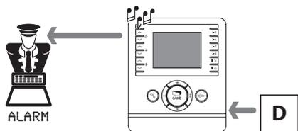
Au cas où serait raccordé à l'entrée dédiée du moniteur un dispositif d'alarme, son activation provoquera l'envoi d'un signal d'alarme au concierge et sera communiquée par le moniteur moyennant signalisation sonore intermittente pendant environ 10".
