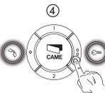
Activation de la communication audio ①, ouverture de la porte du poste externe sélectionné ② et activation des commandes auxiliaires ③ ④.
