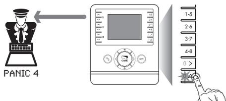
Appuyer pendant au moins 1" sur le bouton  $\Delta$  jusqu'à la réception du signal sonore (bip). Le LED rouge s'allume lors de la confirmation de la réception du signal "Panique" de la part du concierge en même temps que le numéro de l'appelant; la LED du moniteur interne reste allumée jusqu'à ce que le concierge ne rappelle l'utilisateur. La signalisation de "Panique" a la priorité sur tous les appels.
